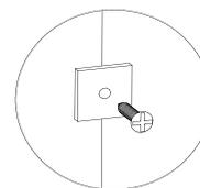
Схема установки скрепки для ДВП (рис.5)
