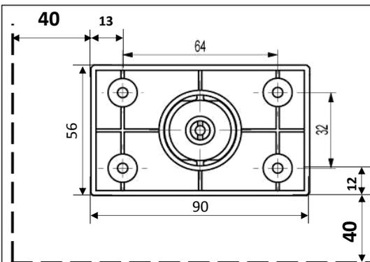
Схема установки опор (рис.3)
