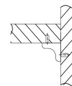
Схема установки фиксирующих полкодержателей (рис.6)
