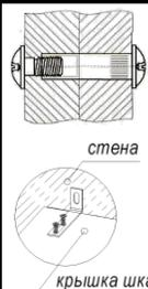
При установке 2-х шкафов рядом, стянуть их между собой межсекционной стяжкой поз.033, для чего необходимо просверлить в стенках боковых сквозные отверстия Ф5 мм.
