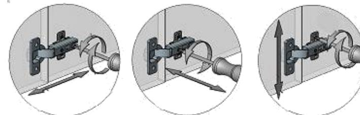
Схема регулировки накладной петли (рис.8)
